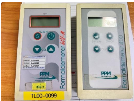
ภาพที่ 2-6 เครื่องมือตรวจวัดสารฟอร์มัลดีไฮด์แบบมือถือ
